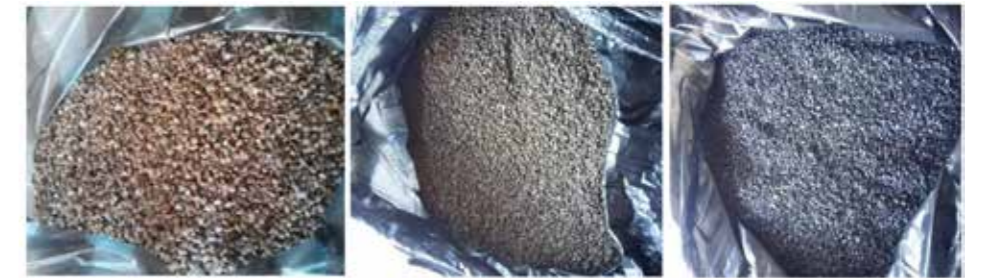
Bahan-bahan Penjernih Air Pasir Silika, Mangan dan Karbon Aktif
