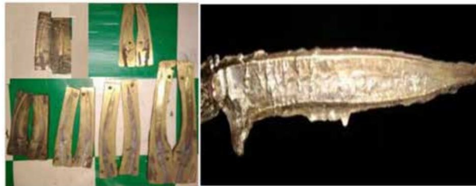
Cetakan logam untuk pengecoran dan Produk bilah rencong hasil pengecoran logam
