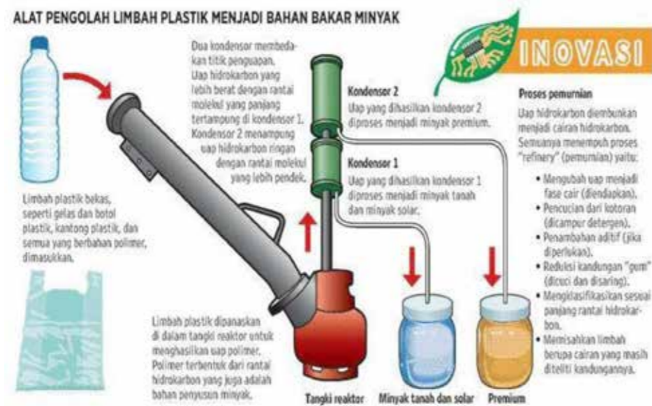
Skema proses produksi limbah plastik menjadi BBM
