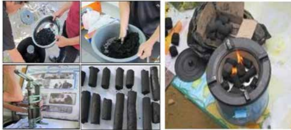
Proses pembuatan biobriket kulit kopi
